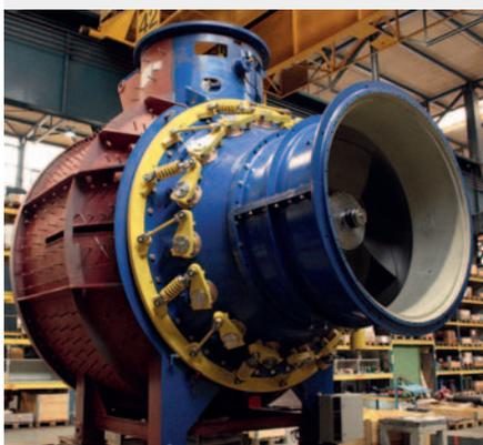
BEW betreibt fünf Flusskraftwerke entlang der Iller, unter welchen sich die Illerstufen V (Fluhmühle), VI (Legau) und VII (Maria Steinbach) befinden. Diese Wasserkraftwerke wurden zwischen 1938 und 1944 erbaut und sind mit STRAFLO-Turbinen ausgestattet. Dabei handelt es sich um einfach regulierte Axialturbinen mit fixer Laufreddstellung und am äusseren Rand der Laufreddschaufeln integrierte Generatorpolschuhe.
