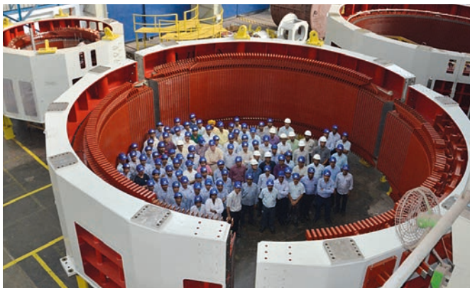
Fabricação do estator para UHE Xekaman 1
