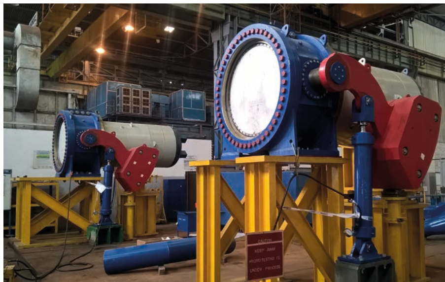
Válvulas borboleta em fabricação
