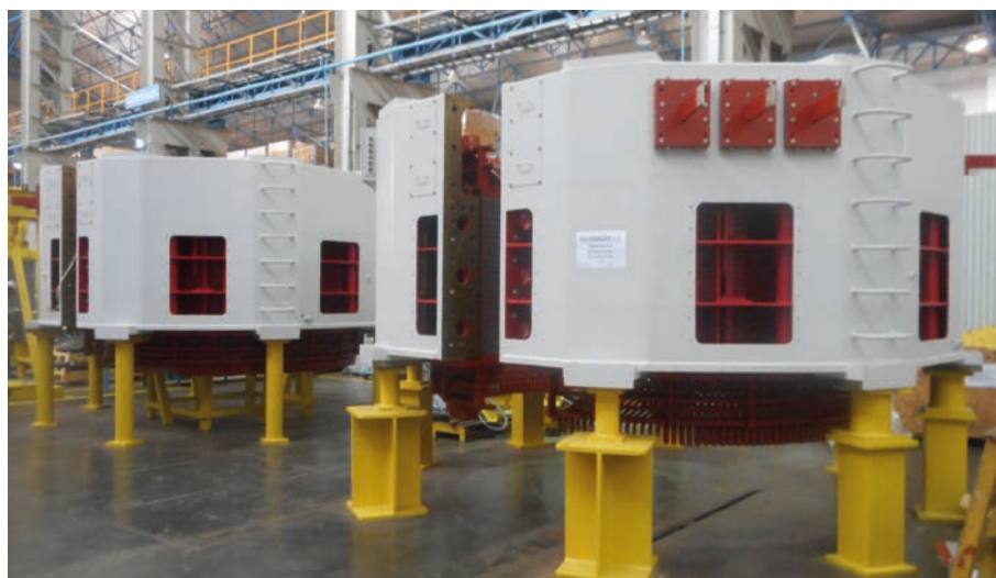
Montagem do estator
